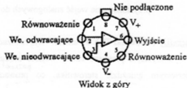
Rys. 1. Wzmacniacze operacyjne zgodne z typem 741: a) schemat układu zasilania i kompensacji napięcia niezrównoważenia ( 10\text{ k}\Omega dla \mu\text{A} 741 ), b) widok obudowy mini-DIP, c) widok obudowy metalowej okrągłej
